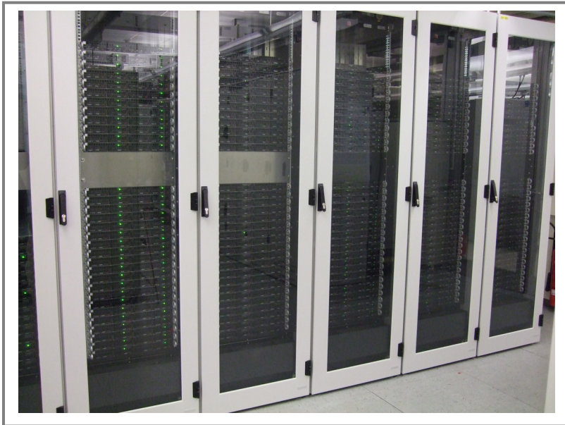
175x Intel® Xeon® Quadcore 1U Twin Cluster-Nodes (=350 Cluster Nodes), integriert in 5 wassergekühlten Serverschränken „Cooltherm“ von Knuerr. ...
